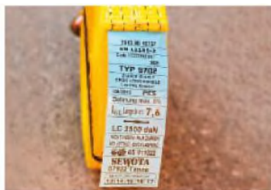
Geeignete Spanngurte (2.500 daN mit blauem Typenschild)
